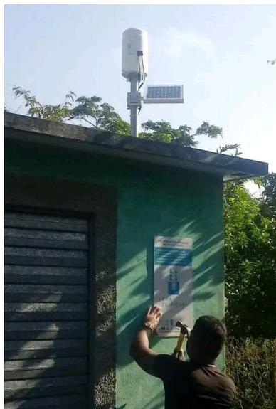
Figura 169. Estación Hidrológica Automática, instalada en el Poblado de tercer orden, Río Blanco.
