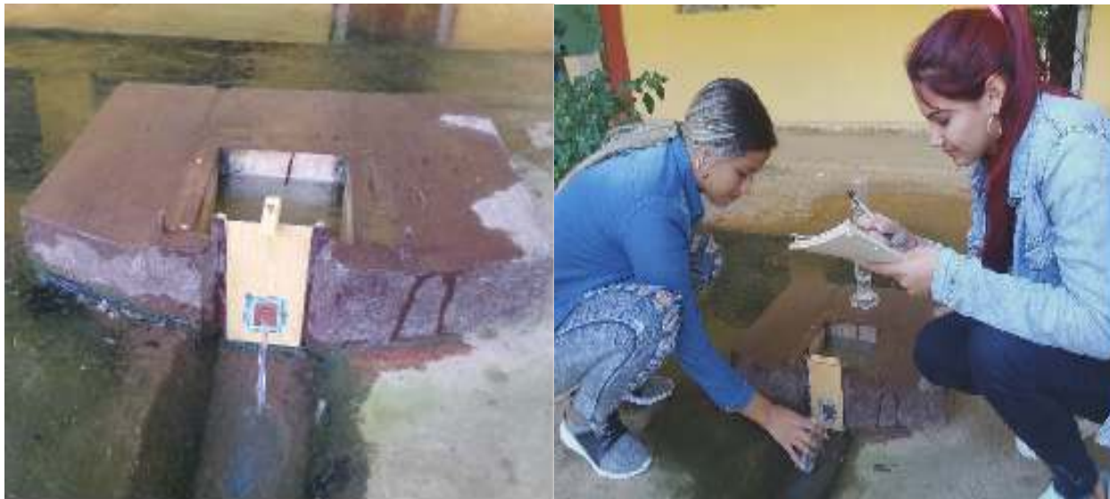
Figura 3. Aforo volumétrico de la obra de toma del embalse.
