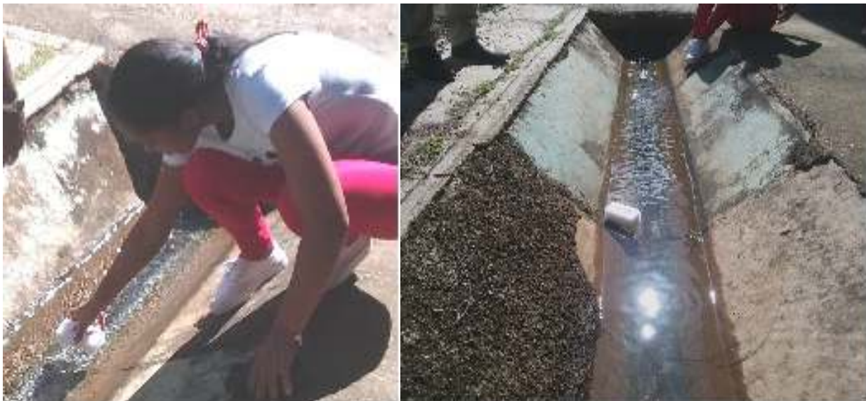
Figura 4. Medición de la longitud recta del canal y colocación del flotador.
