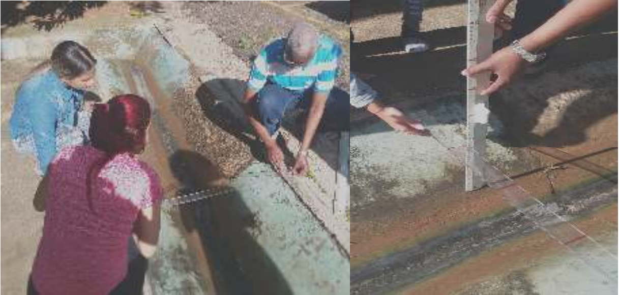
Figura 2. Perfilómetro para la medición de la sección transversal del canal.
