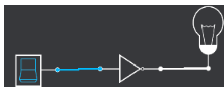
Figura 3. Conexión de los dispositivos del circuito de la función NOT.
