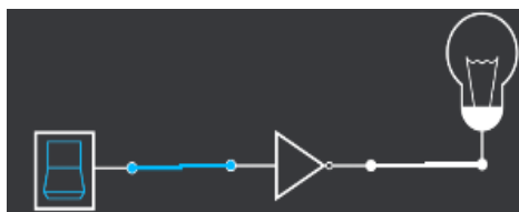
Figura 5. Función NOT. Interruptor activado
