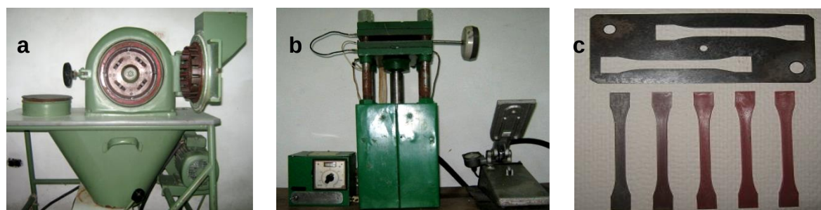
Fig. 3. Obtención de madera plástica. a) Cortadora de cuchillas radiales VEB Maschinen-u-Anlagenbau 8255 Nossen; b) Prensa térmica hidráulica manual de laboratorio; c) molde y probetas del material compuesto.
