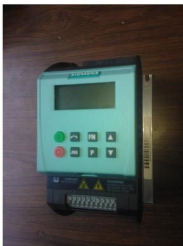
**Figura 2.41:** BOP adaptado al Sinamics G110
