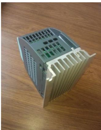
**Figura 2.42:** Disipador de calor adaptado al Sinamics G110
