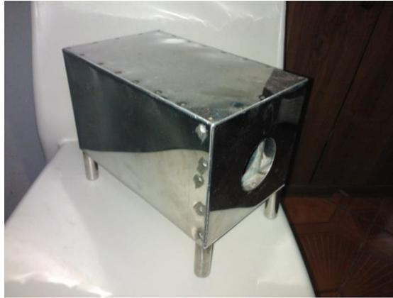
**Figura 2.68:** Chasis metálico de acero inoxidable con recubrimiento de lana
