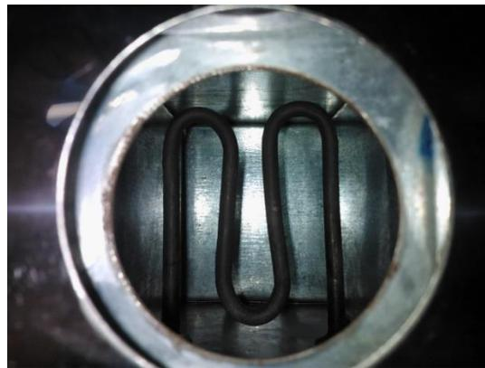
**Figura 2.66:** Resistencia tubular en “M” incluida en un chasis metálico
