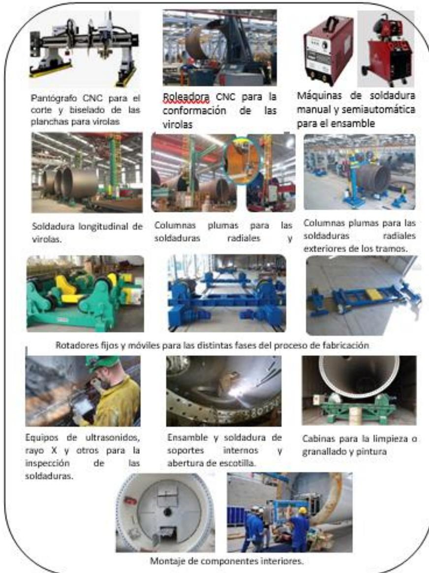
Fig 4: Equipamiento por proceso de fabricación
