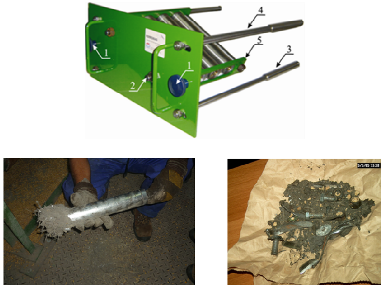
Figura 3. Dispositivo magnético para la extracción de partículas ferrosas.
